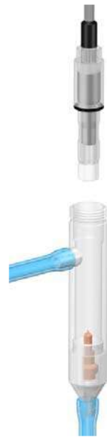
Рис. 3.9. Установка АСрН 2 в измерительную камеру
