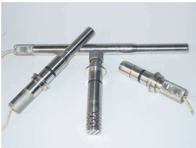
Рис. 3.6. Внешний вид стерилизуемых амперометрических сенсоров АСрН 2 -06.
