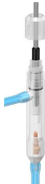
Рис. 3.10. Фиксация АСрН 2 в измерительной камере
